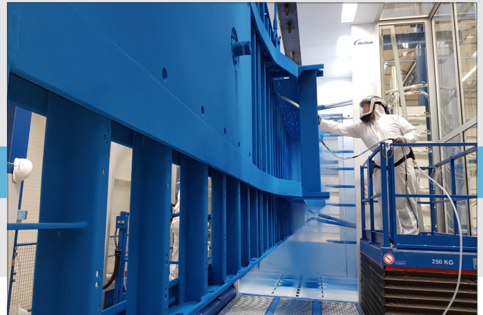
Mitarbeiter pulvern per Hand die für die Automatikpistolen unerreichbaren Areale
