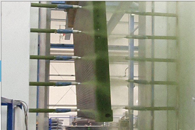
Die Pulverkabinen sind mit jeweils 16 bzw. 20 Automatikpistolen ausgerüstet
