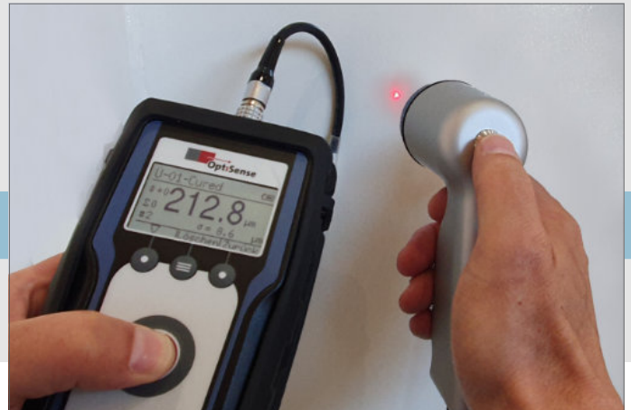
Der PaintChecker Mobile misst nur eine von zwei Schichten: den Decklack
