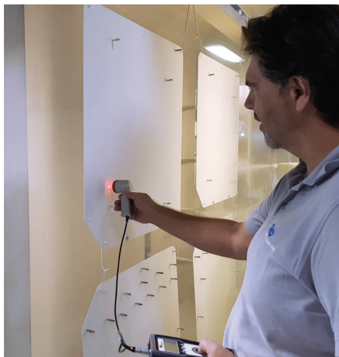
Geschäftsführer Horst Schuller prüft die Schichtdicke mit dem PaintChecker von OptiSense
