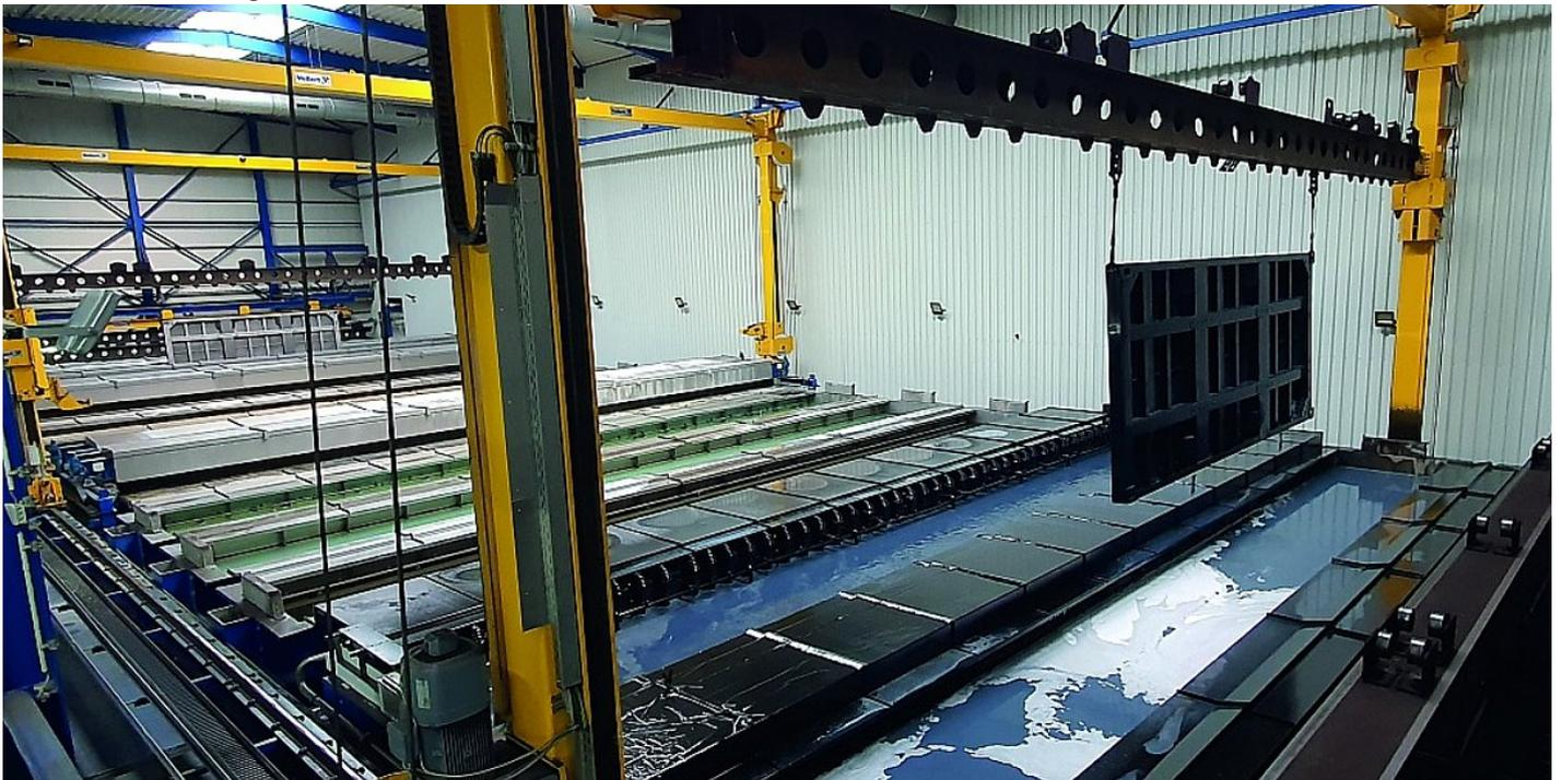
Insbesondere die KTL-Anlage beeindruckt mit Ihren Abmessungen, die Hebevorrichtungen sind so konstruiert, dass die Teile leicht schräg ein- und ausgetaucht werden können, um Luftblasen und Medienverschleppung zu minimieren (Bild: OptiSense)
