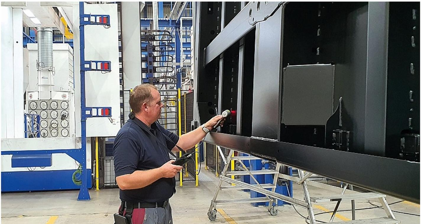
Neben der Dicke der Pulverbeschichtung vor dem Einbrennen kann mit dem OptiSense PaintChecker Mobile auch die dünne KTL-Schicht präzise gemessen werden (Bild: OptiSense)
