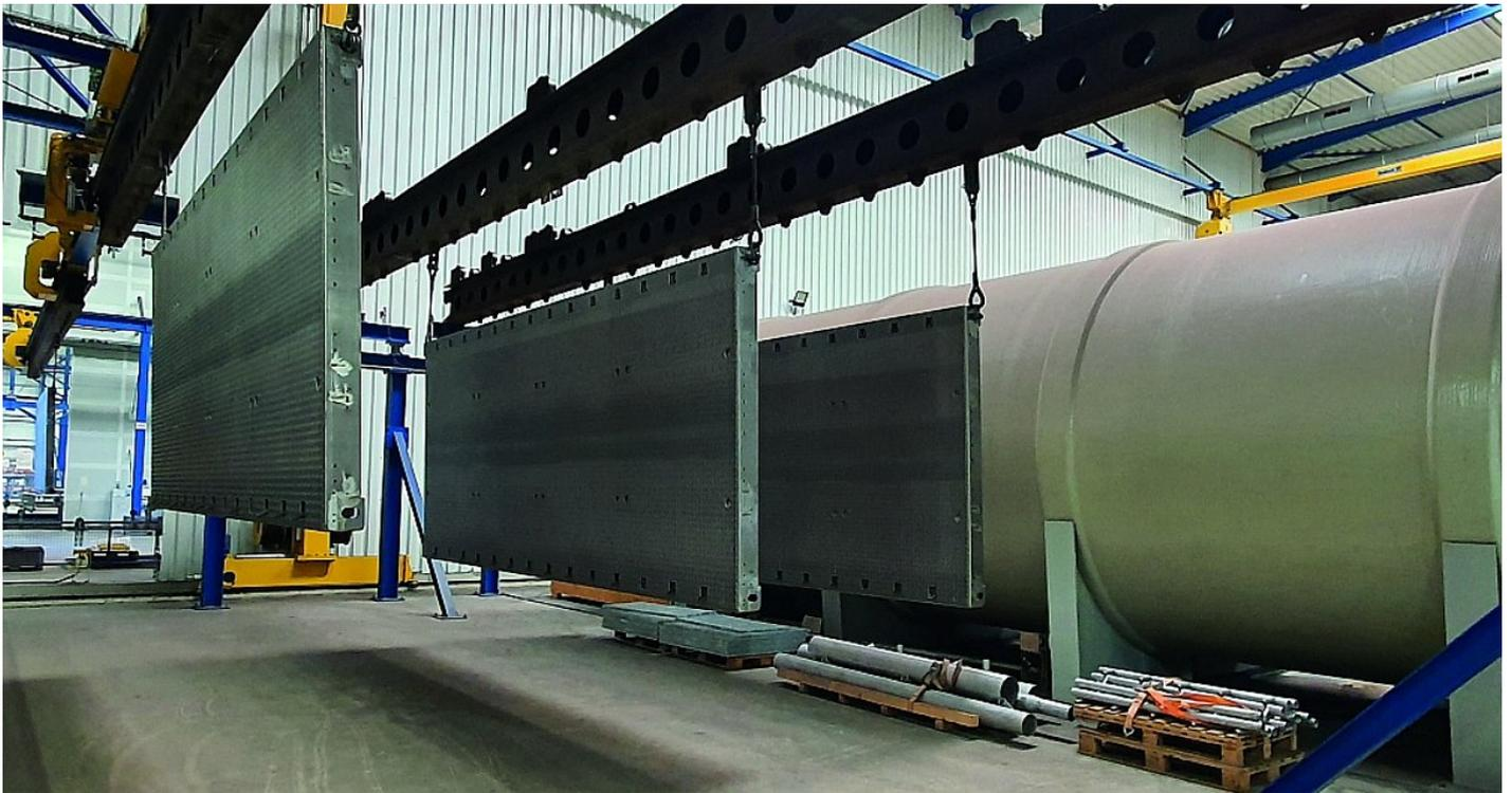
Hier warten einige Großbauteile auf den Durchlauf durch die Strahlanlage, um eine gleichmäßige und für die Lackierung optimal aufbereitete Oberfläche zu erhalten (Bild: OptiSense)
