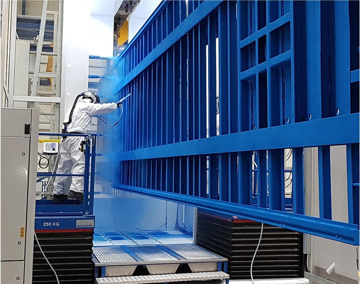
Beschichtung XXL: Hier werden Großteile wie Rahmenschweißkonstruktionen von LKW-Anhängern pulverlackiert (Bild: OptiSense)
